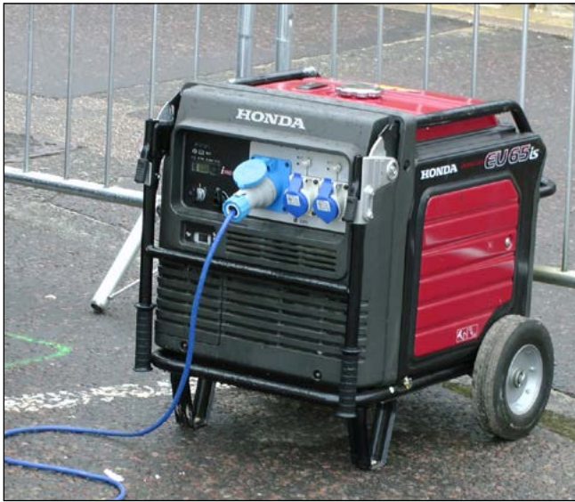
Los generadores deben mantenerse secos y funcionar en superficies secas.
