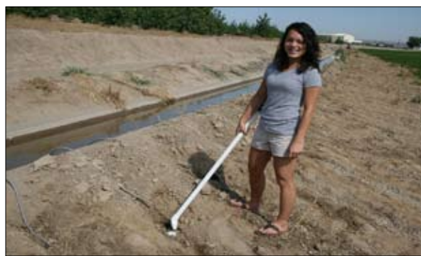
Figura 4. Un dispensador manual de PAM: The Applicator.
